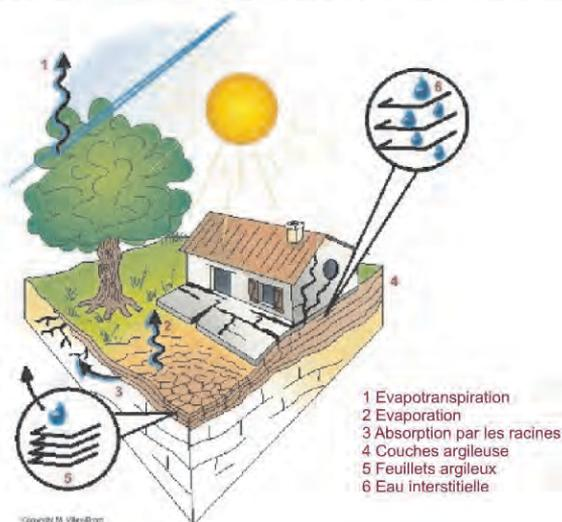
Un sol argileux change de volume selon son humidité comme le fait une éponge ; il gonfle avec l'humidité et se resserre avec la sécheresse, entraînant des tassements verticaux et horizontaux, des fissurations du sol.
