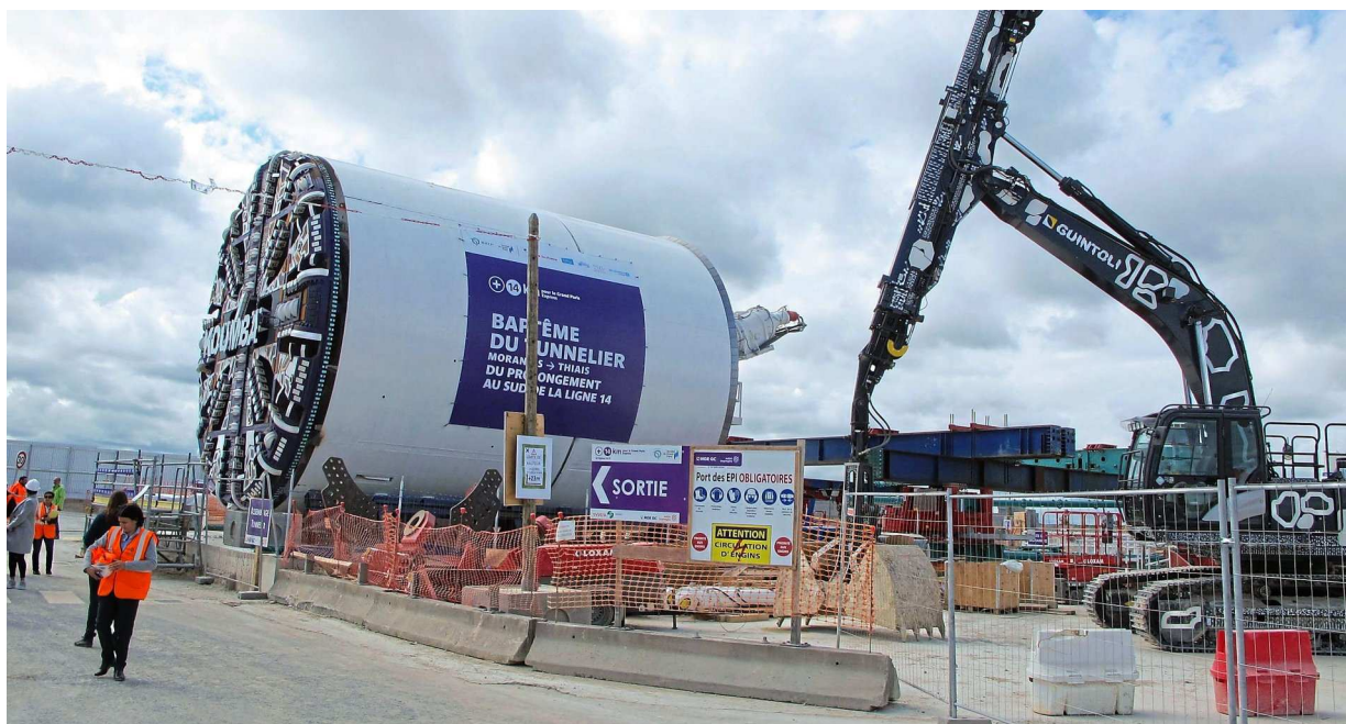
Pour relier Morangis à Orly, le tunnelier Kumba a creusé 3,2 km, en partie sous les pistes de l'aéroport (ici lors de son baptême en avril 2019).
